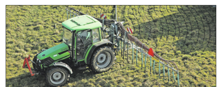
Gute Praxis: Im Talgebiet und Siedlungsnähe soll Gülle mit dem Schleppschlauch ausgebracht werden. (Archivbild BauZ)
